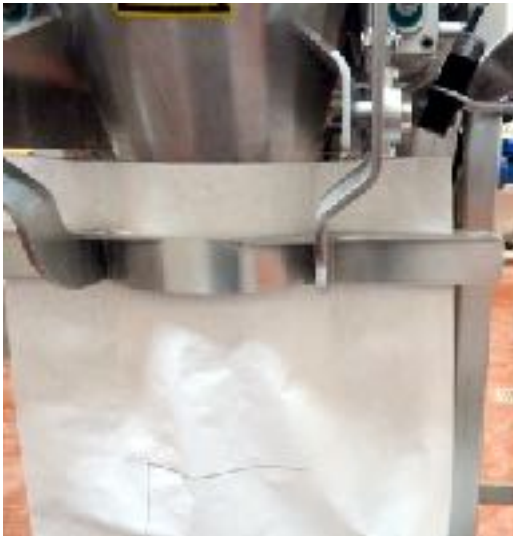
Pneumatisch betätigter Sicherheitssackstutzen
